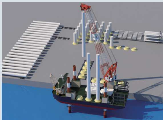
③風車部材積込イメージ(SEP船)
