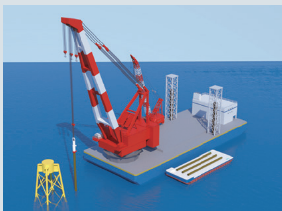
①杭設置イメージ(杭打船)
