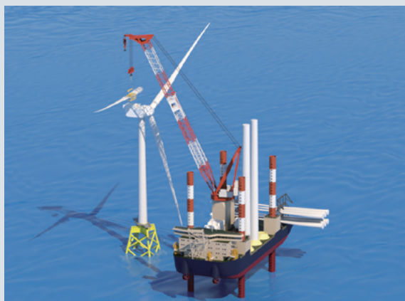
④風車設置イメージ(SEP船)
